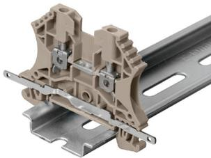
Con el LS 2.8 WDU2.5-10, muchos bornes modulares de paso de la serie W se pueden convertir muy fácilmente. La inserción del LS 2.8 WDU2.5-10 permite pasar el trenzado de apantallamiento del cable directamente por el borne, soldándolo o utilizando un terminal de cable plano adecuado.
